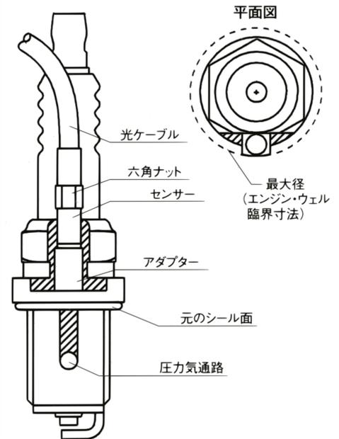
PSIplug (ピーエスアイ・プラグ) は、ユーザーが選び、改造した市販品のスパーク・プラグにオプトランド社の圧力センサーを組み込んだデバイス。センサーは着脱ができ、所定の位置以上に入り込むことはありません。センサーはプラグに加工したアダプター内に、特注のセンサー/スパーク・プラグに見られる長い圧力通路が原因で生じるエラーが最小になるように、スパーク・プラグのキャビティに、できるだけ近づけるように取付けます。市販品のスパーク・プラグが使用できることで、火炎の形態及び伝播特性が影響を受けません。圧力センサーは、オプトランド社が改造した他のスパーク・プラグとの互換性があり、色々な種類のスパーク・プラグを必要とする場合、コストの削減に有効です。
